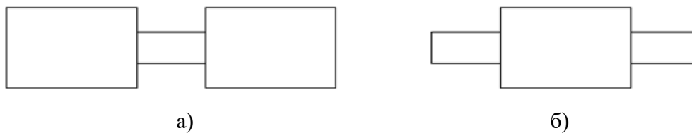
Рисунок 3 – Варіанти конструкції вимірювального трубопроводу а) широкий-вузький-широкий (ШВШ); б) вузький-широкий-вузький (ВШВ)
